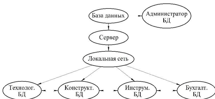
Рис. 1. Структура локальной сети с выделенным сервером
