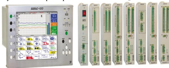
Рисунок 3–Контроллер АСУ ТП БАЗИС-100
